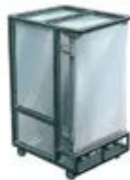
0409 / 0229 Étuve morice mixte Livrée avec 8 grilles. Espace entre les grilles : 8 cm. Ext. : L 74 ; l 96 ; H 135 cm. Int. : L 60 ; l 80 ; H 95 cm. 143 Kg Gaz (0229) : 1 bouteille de gaz butane (20 Kg). Détendeur de 28 mbar. Équipée d'une sonde thermostatique pour le gaz, les rampes se coupent à 180°C et se rallument à 160°C. Électrique (0409) : 220 V / 16A monophasé - 4,5 kW. Répartis entre 2 prises (1,5 kW et 3 kW)
