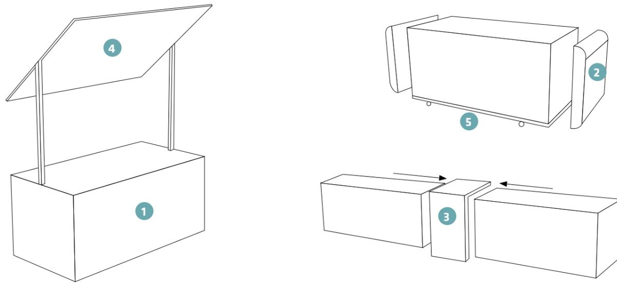
1 Buffet 2 Seitenwände 3 Verbindung 4 Dach 5 Fahrbares Untergestell
