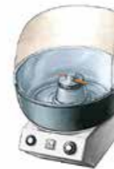
0375 Zuckerwatten - Maschine 220 V / 16A - 2 kW. Ext.: B 60; T 66; Becken Ø 58 cm. Anlaufzeit: 15 Sekunden. Geliefert mit 200 Stäbchen. Zuckerwattenfarbe auf Anfrage. Aussem.: H 42; B 60; T 66 cm; 43 kg (Nicht verbindliches Foto) In Ergänzung: Sucre Seite 215
