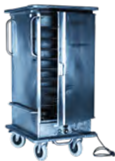
411 Etuve ventilée humidifiée 8 grilles 220 V / 16A monophasé - 2,2 kW. Température maxi : 150°C en 50 min. Livrée avec 8 grilles gn 2/1 (65 x 53 cm). Espace entre les grilles : 10,5 cm. Bloc de ventilation surmonté d'un bac gn 2/1 et d'un Z antivague. Ext. : L 77 l 93 H 162 cm. 135 Kg
