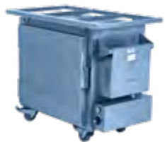
11527 Etuve électrique petit modèle 220/230 V - 16 A monophasé - 2 kW Température maxi 150°C en 30 min - Combiné adaptable pâtissière ou gastronorme 1/1. Fourni avec 5 grilles pâtissières 60 x 40 cm. Espace entre les grilles : 7 cm. Ext. : L 89 P 50,5 H 73 cm. Int. : L 60 P 40 H 45,5 cm
