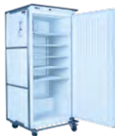
328 Réfrigérateur 140 L 220 V / 16A monophasé - 150 W. Livré avec 3 grilles Ext. : L 65 l 60 H 89 cm. 36 Kg
