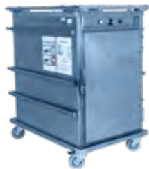
10024 Etuve électrique ventilée 16 grilles Electrique 220 V / 16A monophasé - 3,6 kW. 1 prise. Température maxi : 200°C en 90 min. Livrée avec 16 grilles pâtissières. Ext. : L 79 l 125 H 130 cm. Int. : L 60 l 80 H 85 cm. 217 Kg
