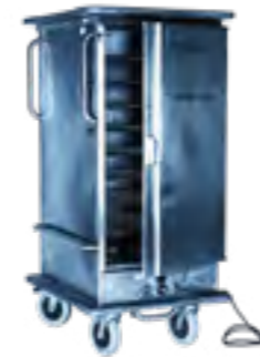
411 Etuve ventilée humidifiée 8 grilles 220 V / 16A monophasé - 2,2 kW. Température maxi : 150 °C en 50 min. Livrée avec 8 grilles gn 2/1 (65 x 53 cm). Espace entre les grilles : 10,5 cm. Bloc de ventilation surmonté d'un bac gn 2/1 et d'un Z antivague. Ext. : L 77 ; l 93 ; H 162 cm. 135 Kg
