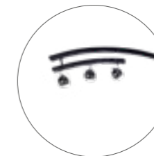
20864 Arc en Ciel avec spots sur alimentation (220 V) + variateur
